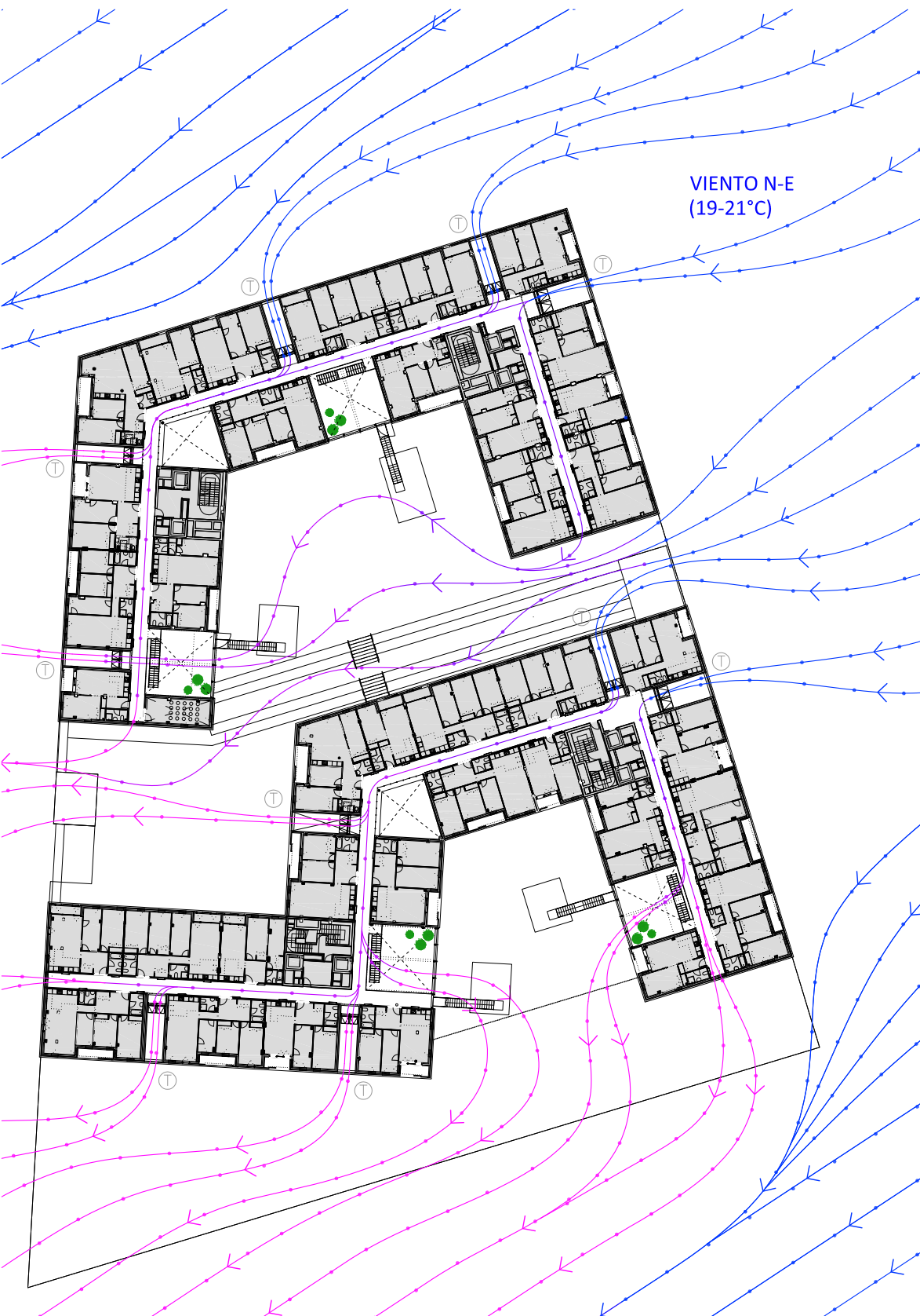
PLANTA DEL CONJUNTO EN EL NIVEL 2 MOSTRANDO VENTILACIÓN NATURAL CON VIENTO NOCTURNO DEL NORESTE. ENFRIAMIENTO PASIVO DE RED DE TOBERAS, Y CONDENSADORES ESCALA: 1/500
